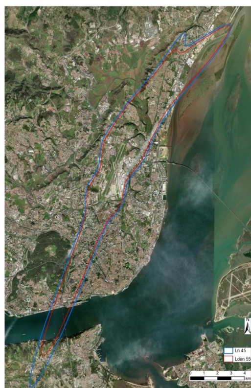
Figura 13 - Pegada sonora do AHD em 2022, considerando o indicador L_{den} (isófona vermelha) e L_n (isófona azul). Fonte: ANA, 2022
